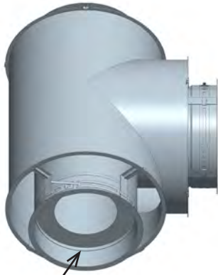
Barrage de graisse position #1
