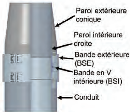
Schéma 67- Cône de finition (EC) installé
