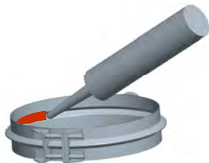
Schéma 6 - Assemblage du joint étape 1
