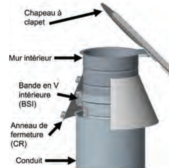
Schéma 69- Chapeau à clapet (FT) installé
