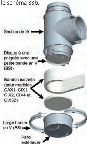
Schéma 33b: Capuchon de té étape 2
