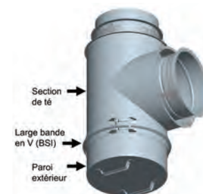
Schéma 33d: Isolement du capuchon de té étape 5 et 6
