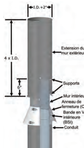
Schéma 71a - Chapeau sans perte de charge (NLC) installé pour I.D. 5" à 13"
