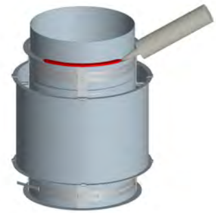
Schéma 7 - Assemblage du joint étape 2
