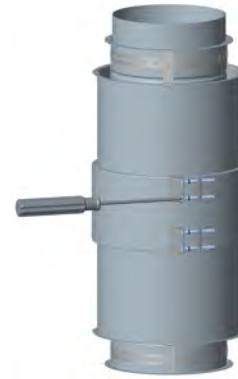
Schéma 11 - Assemblage du joint étape 6
