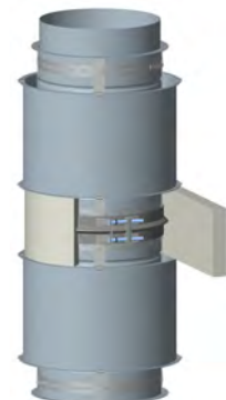
Schéma 10 - Assemblage du joint étape 5
