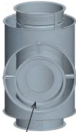
Barrage de graisse position #2
