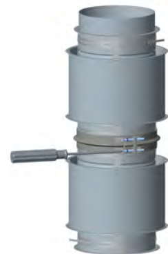
Schéma 9 - Assemblage du joint étape 4
