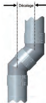
Schéma 36a - Décalage de deux coudes
