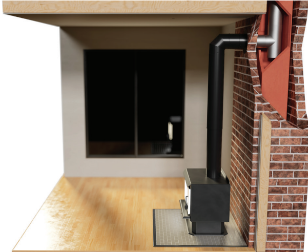
INSTALLATION AVEC CHEMINÉE DE MAÇONNERIE
