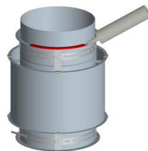
Schéma 7 - Assemblage du joint étape 2
