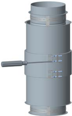
Schéma 11 - Assemblage du joint étape 6
