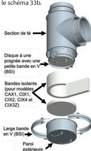
Schéma 33b: Capuchon de té étape 2
