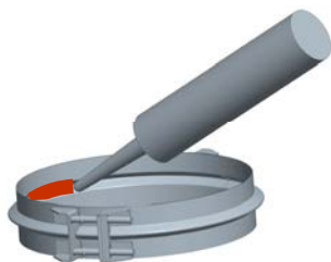
Schéma 6 - Assemblage du joint étape 1
