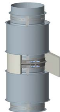
Schéma 10 - Assemblage du joint étape 5
