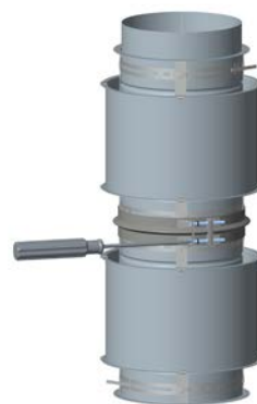
Schéma 9 - Assemblage du joint étape 4
