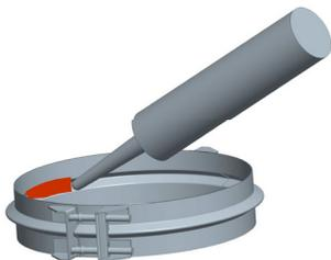
Schéma 6 - Assemblage du joint étape 1
