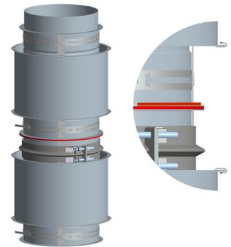
Schéma 8 - Assemblage du joint étape 3
