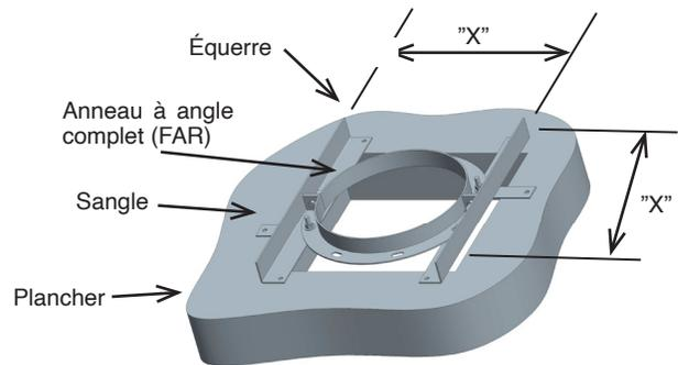
Schéma 49 - Guide de plancher robuste (FGHD)
