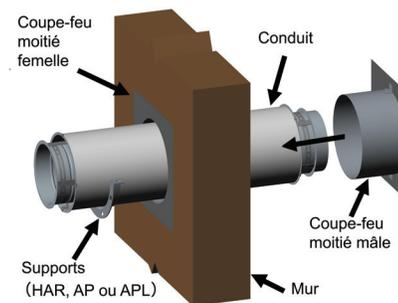
Schéma 115: Supports pour cheminée traversant un mur
