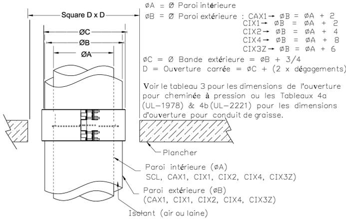
L'ouverture requise lors de l'installation des modèles SecureStack PRO dans une application de chauffage de bâtiment ou de conduit de graisse (UL-1978 et UL-2221) à travers un toit, un plancher ou un mur fait de matériaux combustibles.
