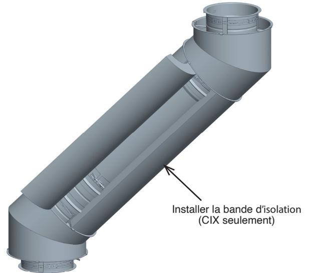
Schéma 28 - Étape 12 - Installer la bande d'isolation
