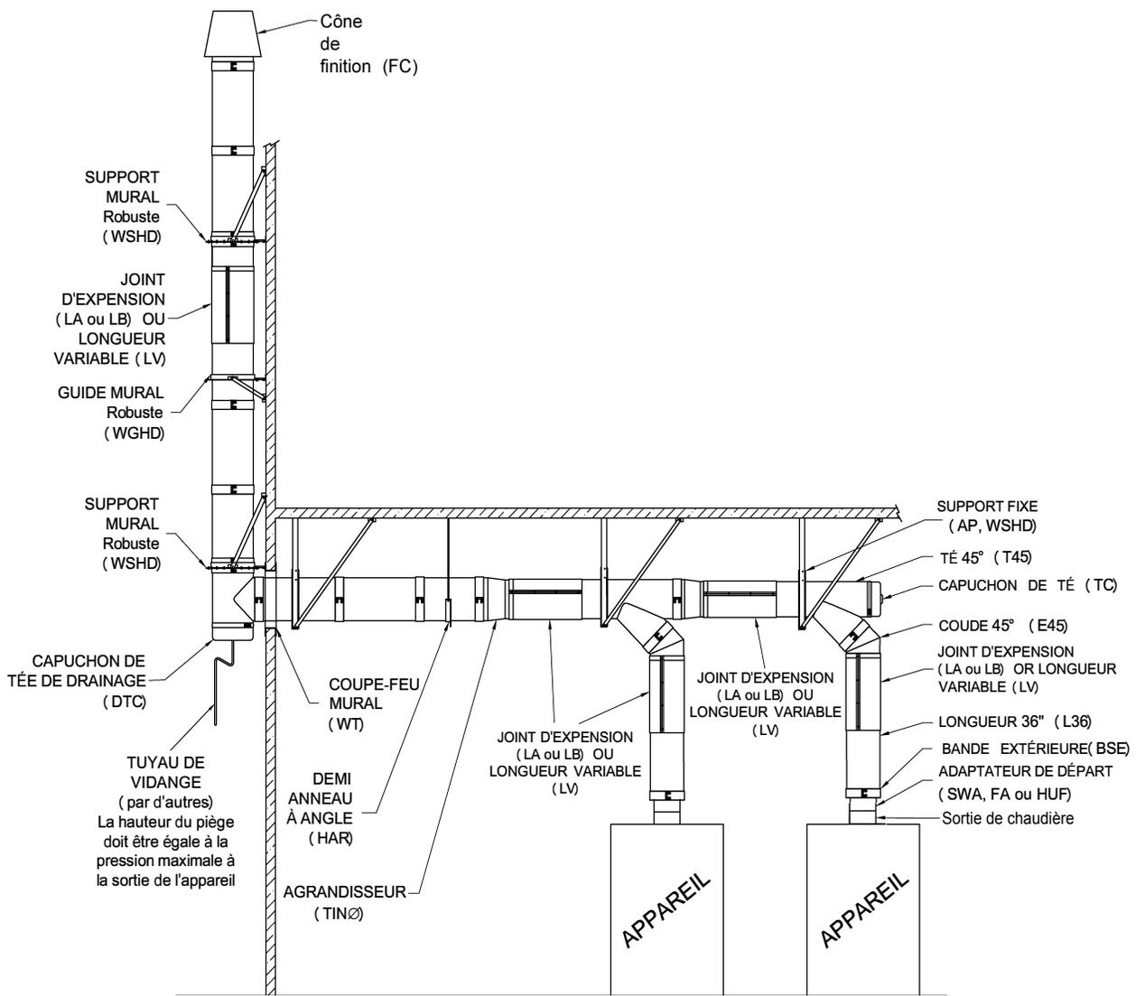
Schéma 84 - Exemple d'installation pour chaudières
