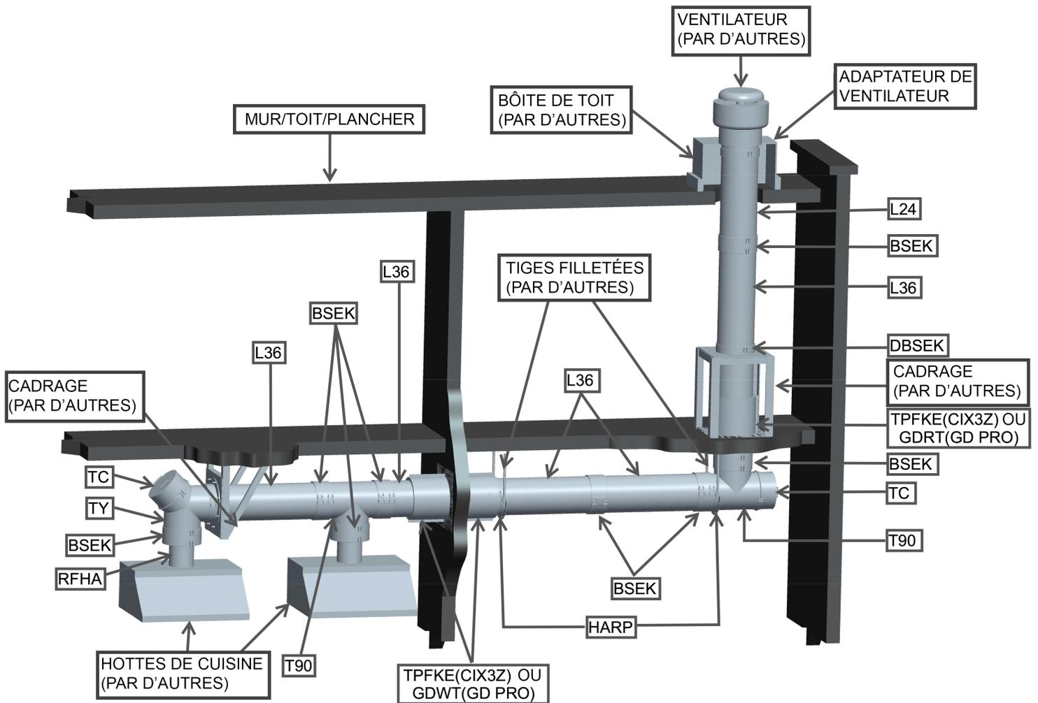
Schéma 82 - Exemple d'installation d'un conduit de graisse
