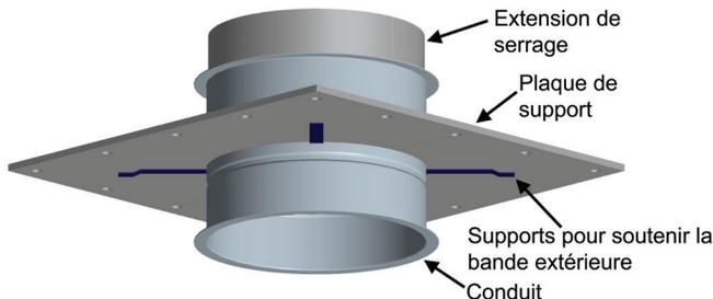
Schéma 43 - Plaque d'ancrage avec longueur (APL)
