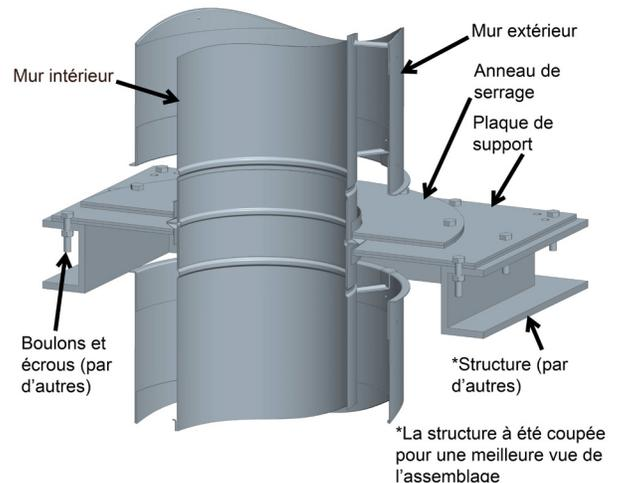
Schéma 41a - Plaque d'ancrage sur la charpente
