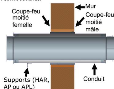
Schéma 116: Supports pour cheminée traversant un mur
