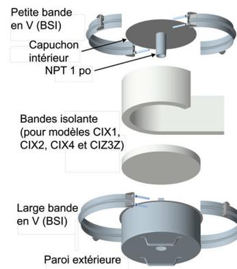
Schéma 34: Capuchon de té de drainage (DTC)
